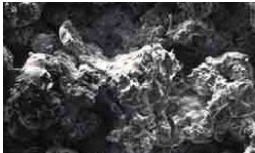
obr. 1 Mikroskopicky zvětšený kombinovaný povrch s hydroxyapatitem
