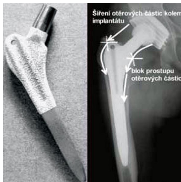
obr. 5 Dřík MEDIN MT s nástřikem a schéma šíření otěrových částic kolem femorální komponenty
